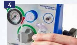
Spray-Set-Filter am EasySpray anschließen. Den blauen Filter an den blauen Luer-Anschluss (weiblich), den transparenten Filter an den männlichen Luer-Anschluss anschließen.
