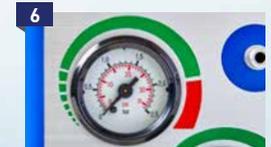
Das Manometer des EASYSPRAY-Geräts auf den entsprechenden Druckbereich von 1,5 bis 2,0 bar (21,8 bis 29 psi) überprüfen. Den gewünschten Druck durch Drehen des schwarzen Druckreglerknopfs einstellen.
