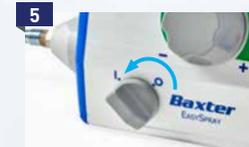
Den Ein/Aus-Schalter an der Vorderseite des EASYSPRAY-Geräts auf die EIN-Position drehen. Die Akkuanzeige leuchtet nur auf, wenn der Akku schwach ist und wenn der Gasfluss aktiviert wird. Wenn der Akku vollständig leer ist, leuchtet die Akkuanzeige nicht auf.
