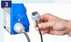
EasySpray mit einem geeigneten Verbindungsschlauch an den Anschluss für medizinische Luft anschließen. Der Versorgungsdruck muss zwischen 3,5–7,0 bar (51 bis 100 psi) liegen.
